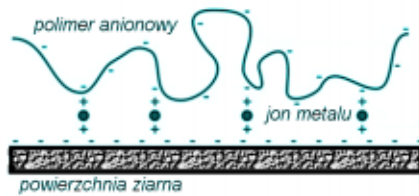
Rys. 3. Jon metalu mostkujący łańcuch polimeru anionowego z ujemnie naładowaną powierzchnią ziarna (Tarleton i Wakeman, 2007)
