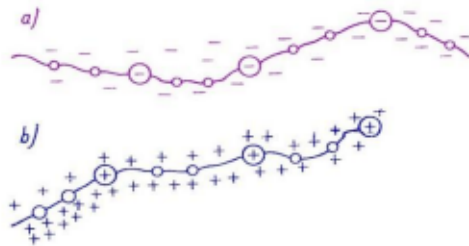
Rys. 1. Dysocjacja flokulanta w wodzie. a) flokulanta anionowego, b) flokulanta kationowego (Nowak, 1982)
