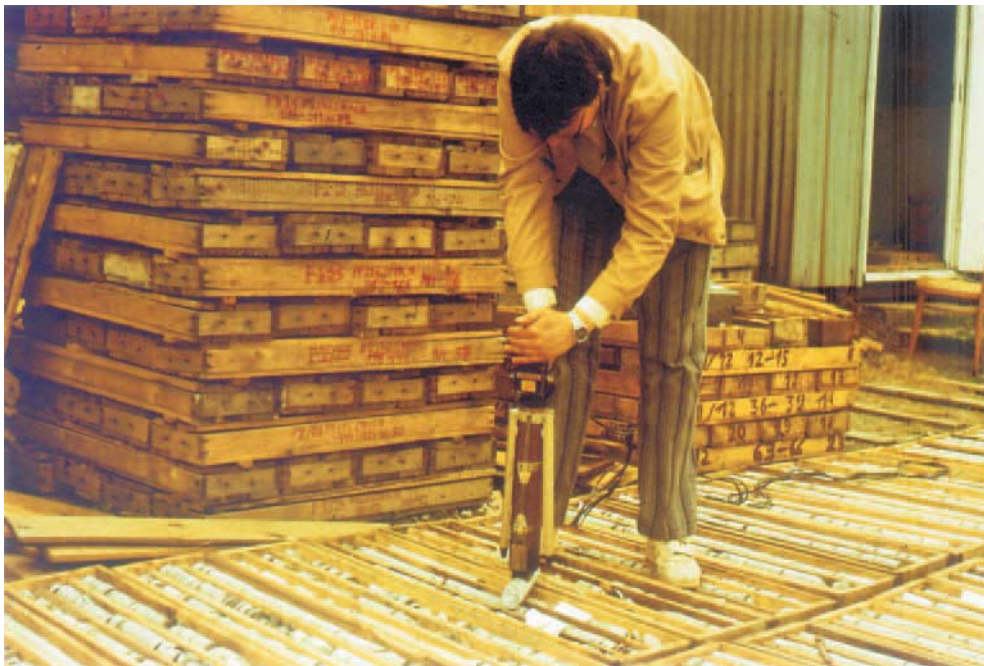
Rys. 6.4. Opróbowanie rdzeni wiertniczych ze złoza cyny w Gierczynie przy pomocy przenośnej aparatury rentgenofluorescencyjnej (fot. M. Nieć)
