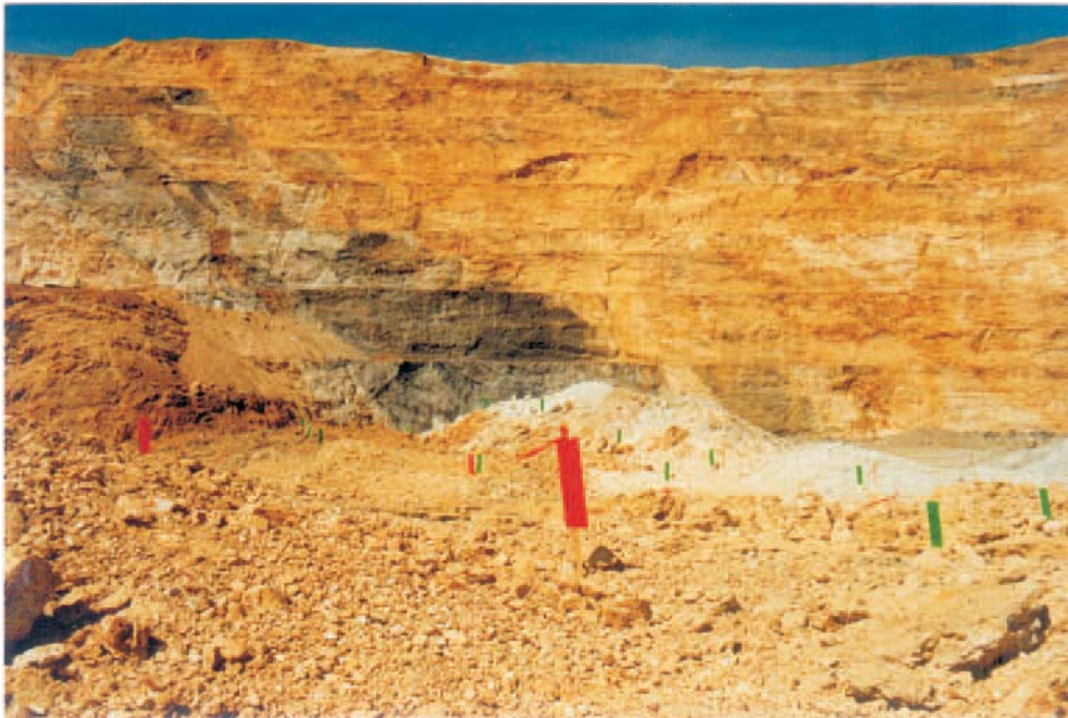
Rys. 3.11. Przygotowanie do pobrania próbki urobkowej (złóże Au, Carlin, Newada USA – fot. M. Nieć) kolorowe chorągiewki oznaczają miejsca pobrania dwóch typów rud
